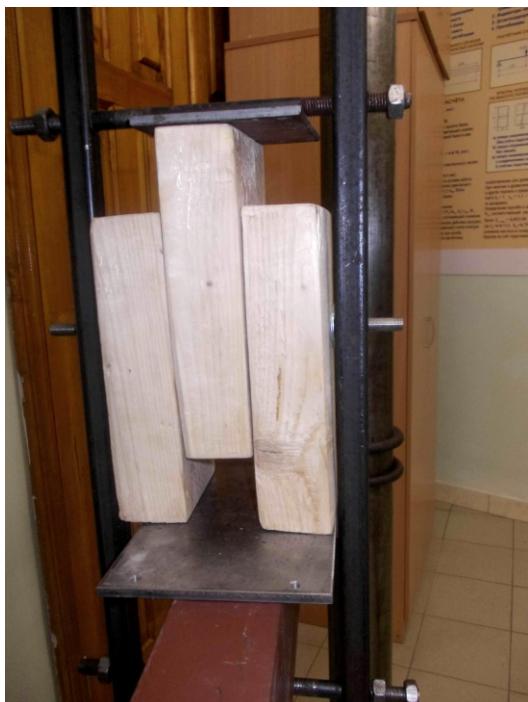
Собранный узел деревянной конструкции на испытании
